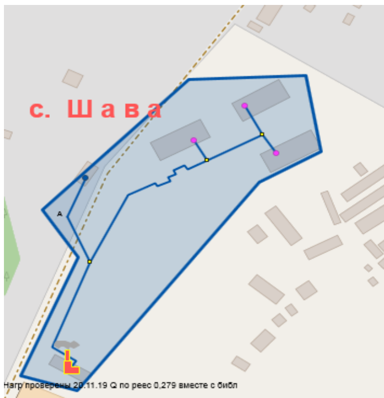
Рис. 2.1.2. Зона действия котельной с. Шава
