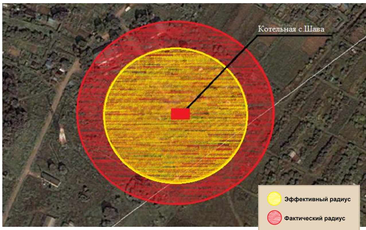
Рис. 7.15.2. Эффективный радиус теплоснабжения котельной с. Шава
